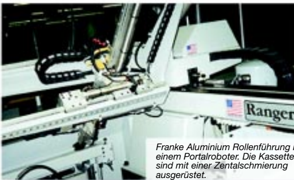
Die Raffmaschine für Kunststoffe wurde nach neuestem Stand der Technik entwickelt. Für die zentrale Horizontalbewegung wird eine schnelle und leicht laufende Aluminium Rollenführung eingesetzt. Die großdimensionierten, nadelgelagerten Laufrollen nehmen Belastungen aus allen Richtungen auf. (Foto SMB)
