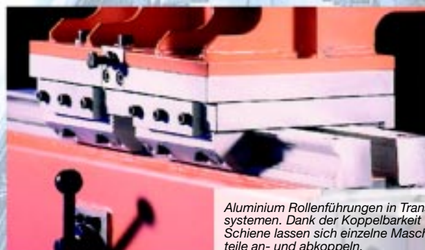
Franke Aluminium Rollenführung in einem Bearbeitungszentrum. Parallele Doppelschienen mit Kassetten führen die Verfahrenseinheit entlang dem Werkstück. Der Antrieb erfolgt über eine Zahnstange. (Foto KOSOMA)
