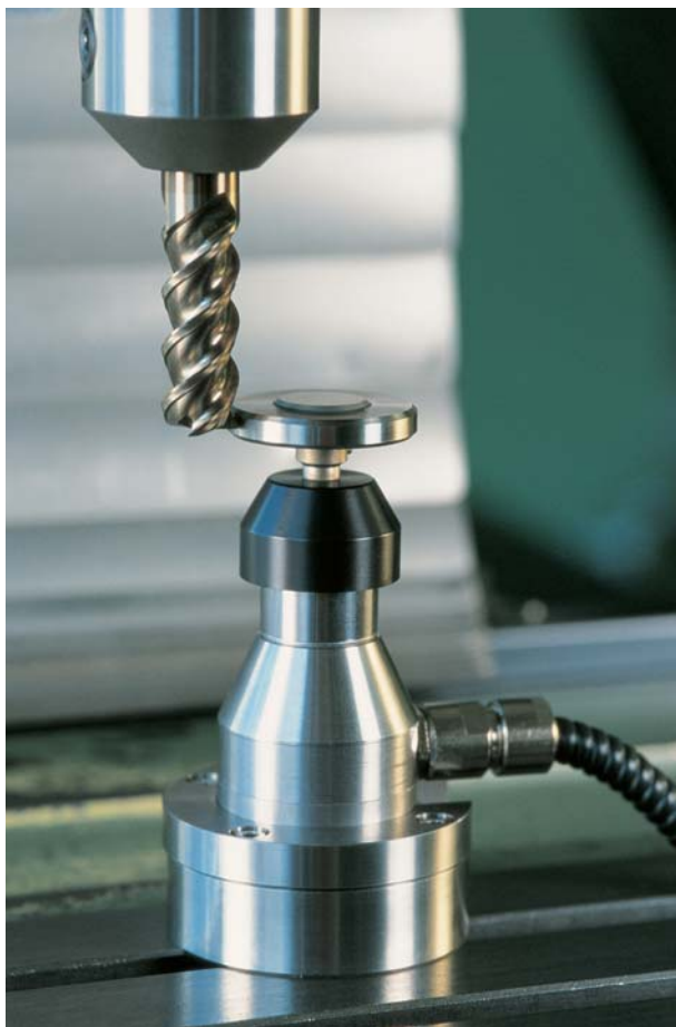
Schaltendes 3D-Tastsystem zum Vermessen von Werkzeugen mit stehendem oder rotierendem Werkzeug
