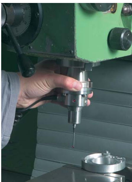
CNC-Maschine mit manuellem Werkzeugwechsel
