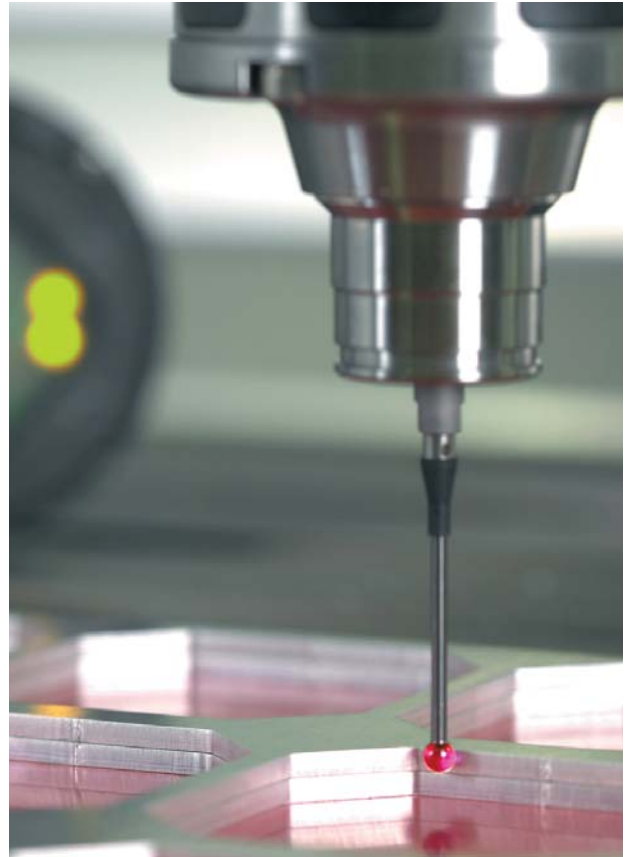
Schaltendes 3D-Tastsystem zum Werkstück-Ausrichten und -Vermessen
