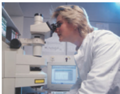
FT-Infrarotspektrometer zur Identifizierung von Schmierstoffen
