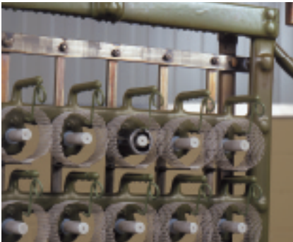
Auch eine INA-Entwicklung: Beschichtungsgestell, für die Corrotect®-Beschichtung von Kugelhülsen
