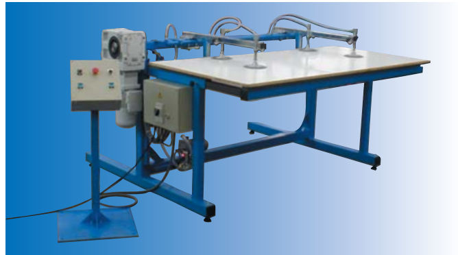
VacuStand VS II-180E in Ablageposition. Der Ablage Tisch kann durch Herausziehen der äußeren Ablagekante an unterschiedliche breite Werkstücke angepasst werden.
