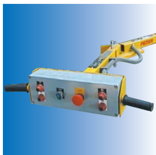
Manipuliergriff mit seitlicher Schwenkvorrichtung für überlange Hölzer.
