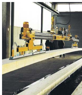
VWLB mit motorisch verstellbaren Saugplatten
