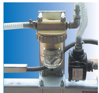
Wasserabscheider für feuchte und leichtnahe Hölzer oder Bohlen.
