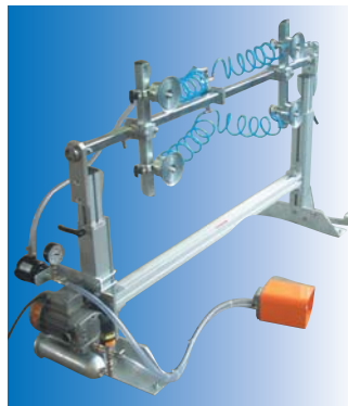
VacuStand II-AL mit Querträger und insgesamt 4 Saugplatten
