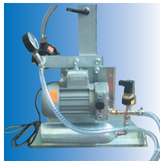
Vakuumerzeuger mit Rückschlagventil, Eco-Modul und Sicherheitsspeicher
