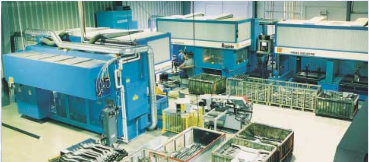
Endenbearbeitung der Hydroformteile durch 3D-Laserschneidmaschinen Machining of the ends of hydro-formed parts by means of 3d laser cutting machines
