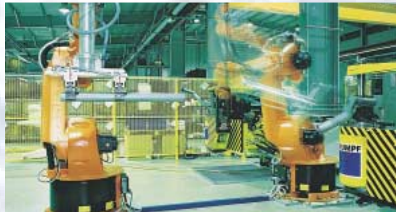
Unsere CNC-Rohrbiegemaschinen MR 65 können sowohl automatisch als auch manuell bestückt werden Our CNC tube bending machines MR 65 can either be equipped automatically or manually
