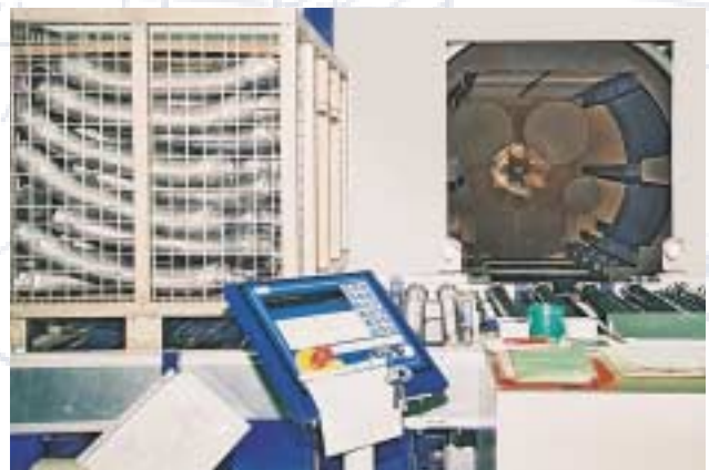
Waschanlage, Entfettung und Konservierung in einer Kompaktwaschanlage der Firma Dürr-Ecoclean Washing plant, degreasing and preservation in one compact washing plant of Messrs. Dürr-Ecoclean
