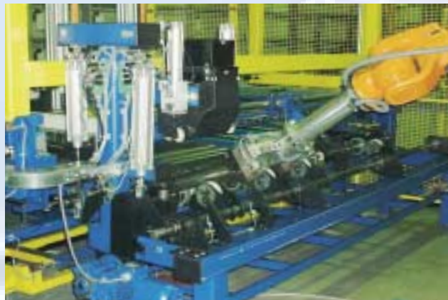
Entnahmeroboter für CNC-Rohrbiegemaschine aus dem Magazin mit Schweißnahterkennung Robot for the removal from the magazine of a CNC tube bending machine with weld recognition
