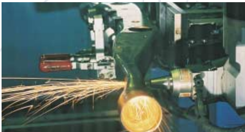
3D-Laserbeschnitt von Konturen und der Enden – hochpräzise und genau durch CO 2 -Laserbearbeitungsmaschine 3d laser cutting of contours and ends - highly precise and exact by means of Co2 laser machining
