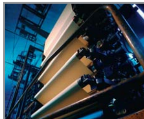
Bei der Herstellung von Papier überwachen Infrarothermometer der Serie Thermalert den Trocknungsprozeß. Das Ergebnis: höherer Ertrag, geringere Stillstandszeiten.
