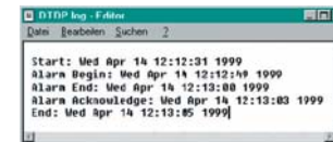
Im Fehlerfall wird der Zeitpunkt des Alarms in einer Alarm-Datei gespeichert.
