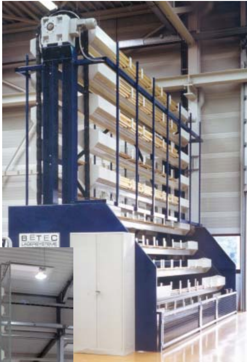
LPN mit einer Beladenase für Messingrohre
