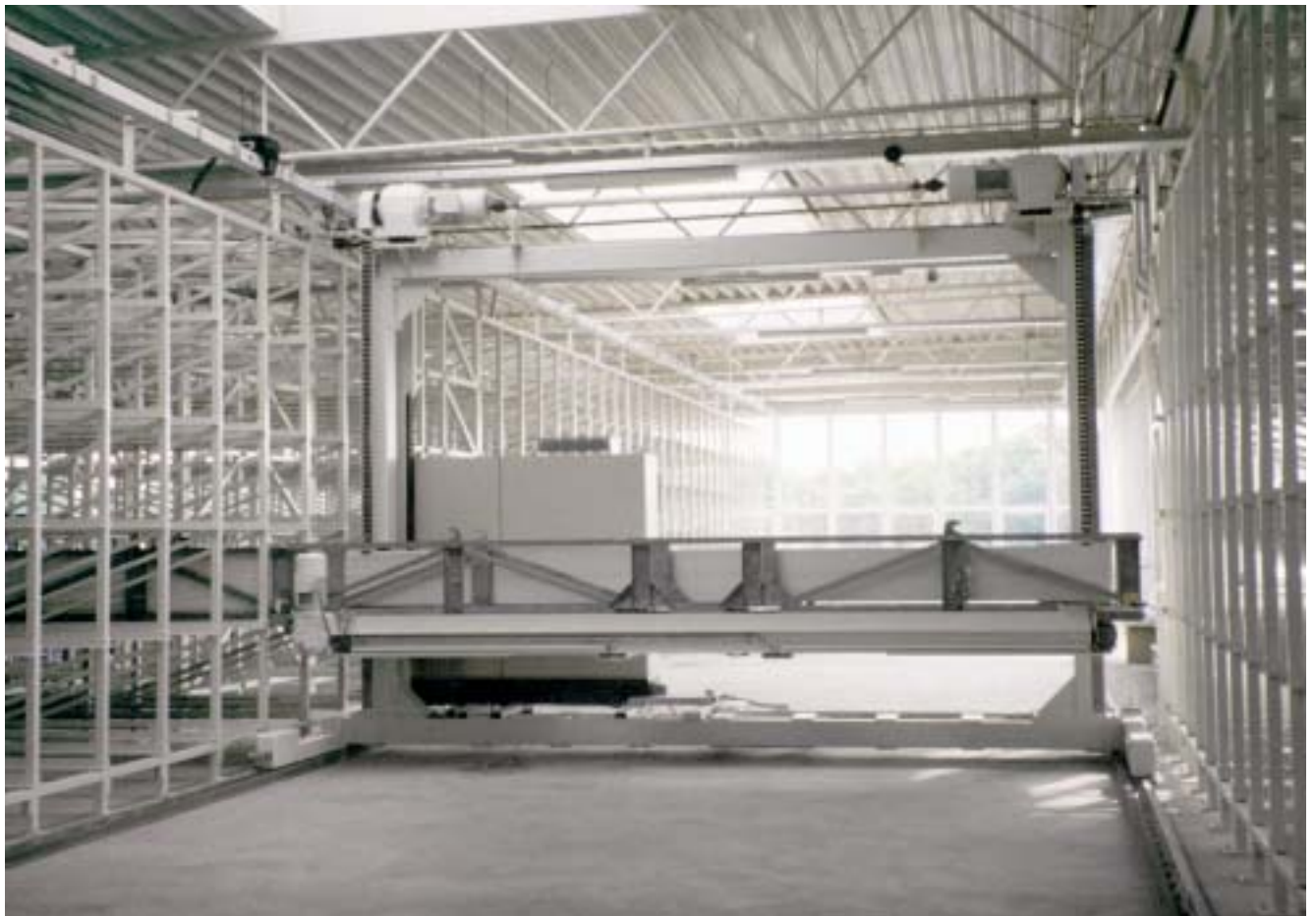
AWL-Langgutlagerung im Blocksistem - für die verschiedensten Kassettentypen möglich.
