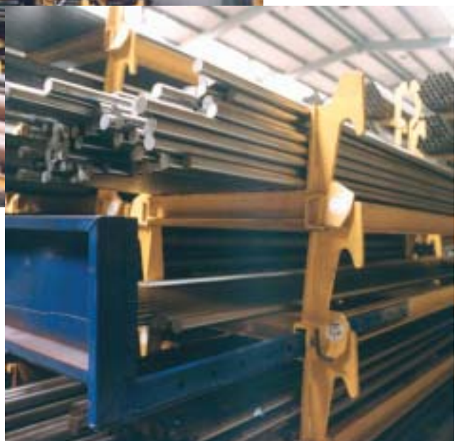
SLL mit Rutschsicherung für glatte Wellen
