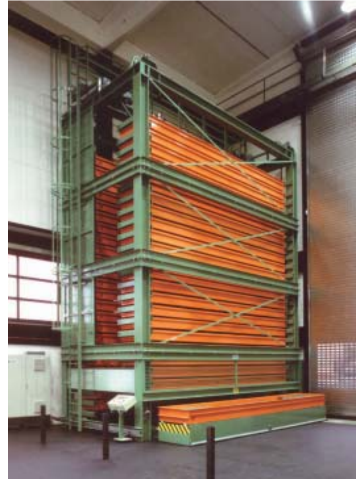
LLT mit 3 to Kassetten und einem querausfahrenden Wagen als Belade- und Entnahmestation
