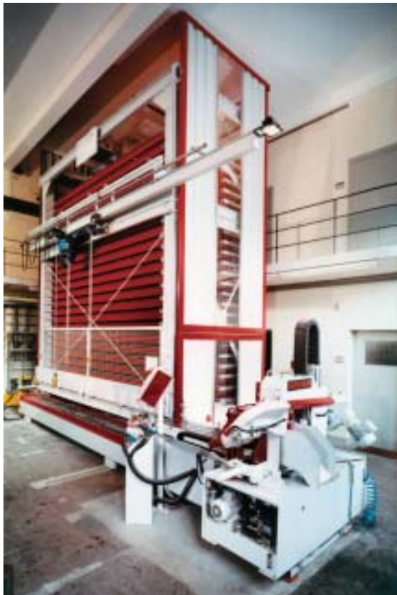
LLT mit 1 to Kassetten, querausfahrendem Wagen als Belade- und Entnahmestation sowie angebundenem Bandsägeautomaten und integrierter Kranbahn
