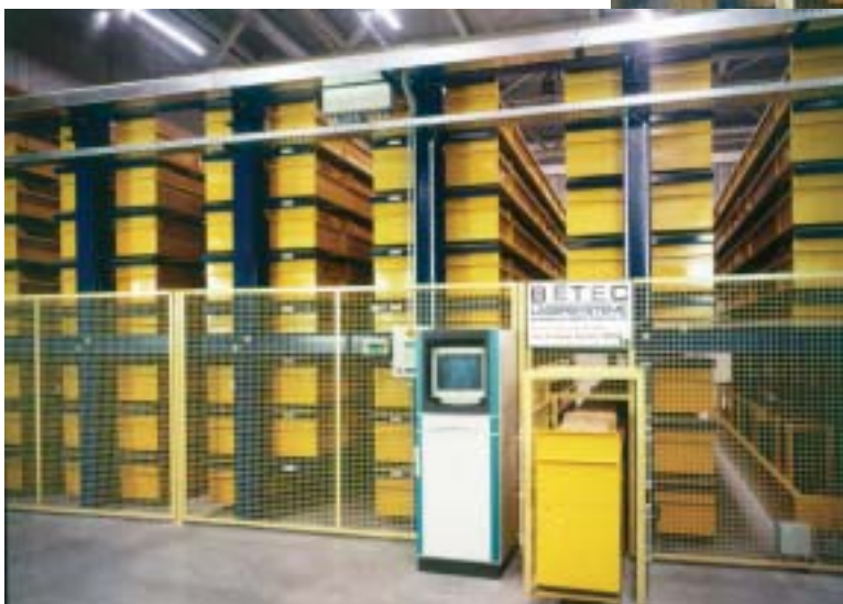
ASLL mit PC-geführter Lagerverwaltung und einer Ein-/Aus-Lagerstation mit absenkbarer Kassettenvorrichtung.
