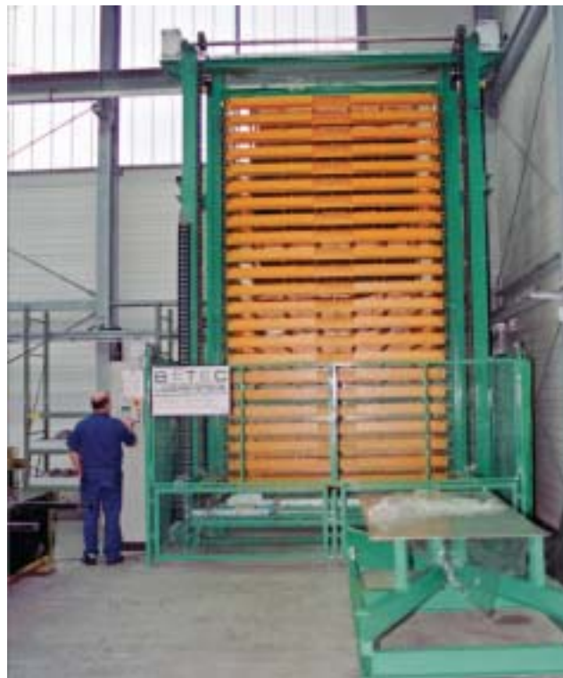
TBL I einzeiliger Blechlagerturm für Großformatbleche mit 23 Paletten a 3 to sowie einem Entpalettierwagen
