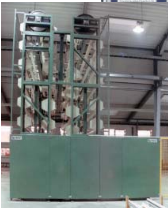
Mehrschlingenpaternoster mit einer Beladenase für Fensterprofile
