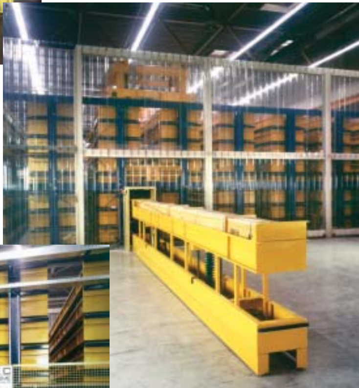
ASLL mit PC-geführter Lagerverwaltung und einer Ein-/Aus-Lagerstation mit absenkbarer Kassettenvorrichtung.
