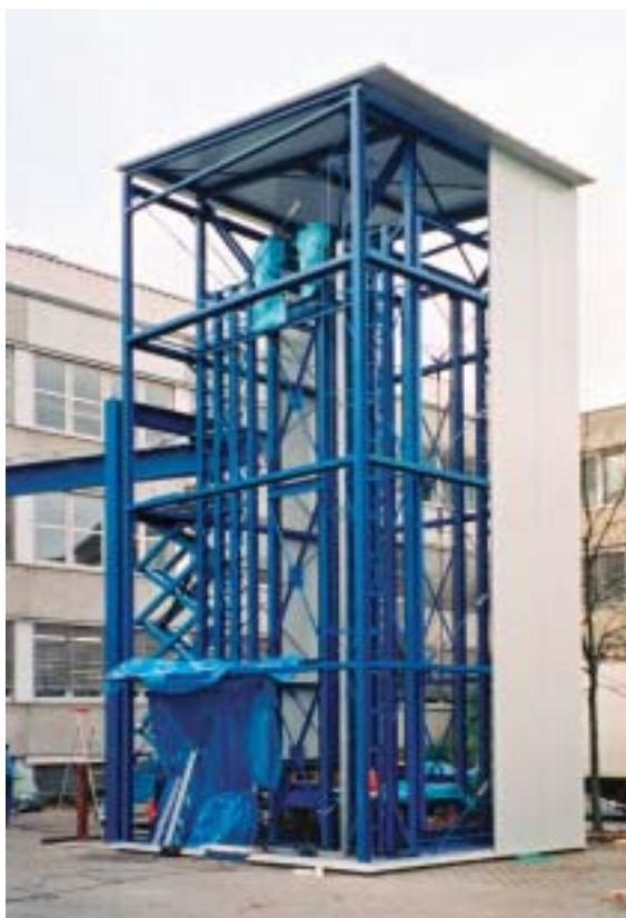
TBL II zweizeiliger Blechlagerturm, außen stehend, verkleidet mit ISO-Wänden.
