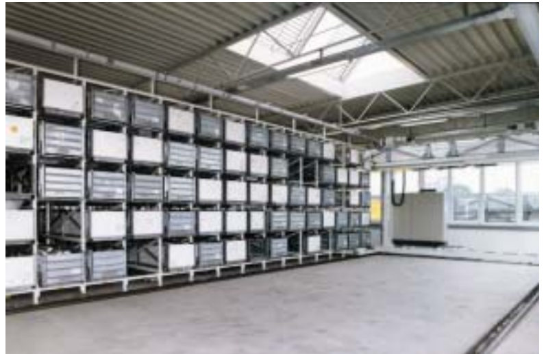
AWL-Langgutlagerung im Blocksistem - für die verschiedensten Kassettentypen möglich.
